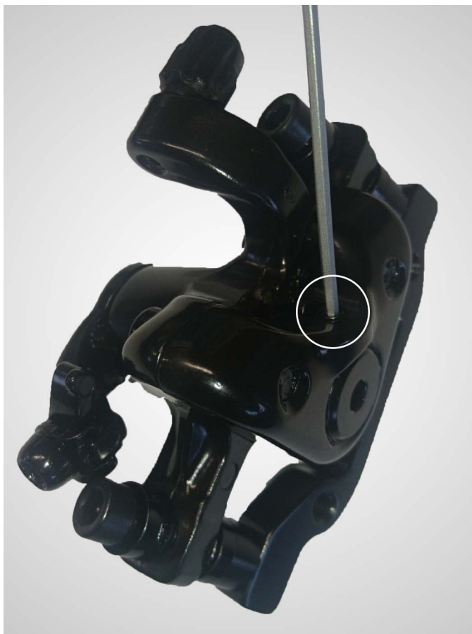
Abb. 15: Lösen der 2 mm Madenschraube
