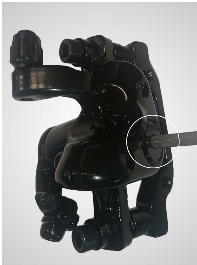
Abb. 16: Lösen des 5 mm Bremsbackenstellers
