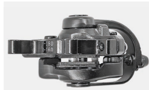
Synchron bewegte Scheibenbremsattel
