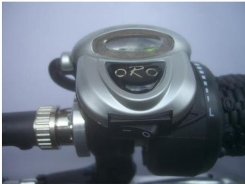
Nach ca. 2 Minuten schaltet sich die Steuerelektronik aus. Zum Losfahren müssen Sie deswegen den Ein-/Ausschalter betätigen. Wenn Sie mehrere Tage den Motor nicht benutzen, ziehen Sie wenigstens 1 Batteriestecker, um eine Entladung zu verhindern.
